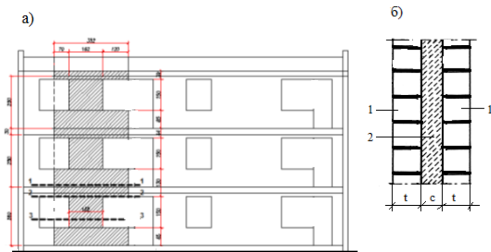
1 – керамикалық тастардан қалау, 2 – құйма пенобетон 8.4-сурет – Үш қабатты үй қабырғасы (а) және оның тік қимасы (б)
